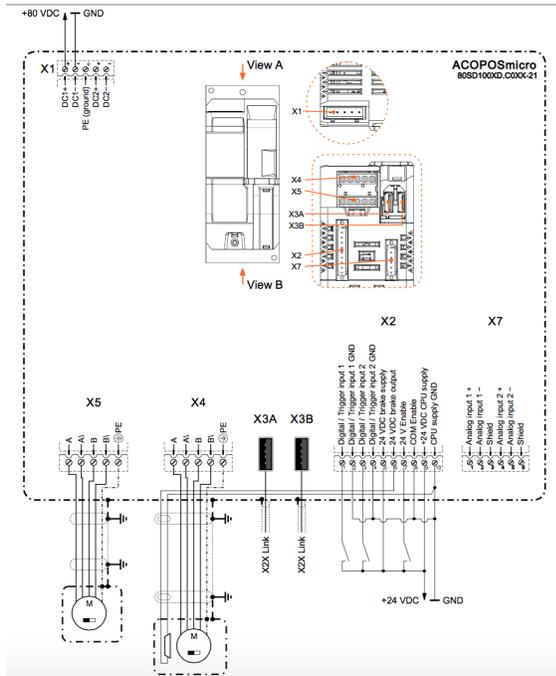
Fig. 31: D100 Driver Schematic [28].
