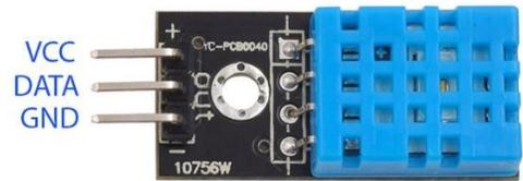
Fig. 7. Adafruit DHT11 Sensor [17]
