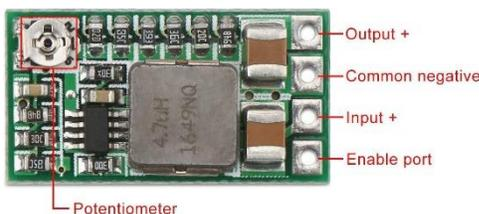
Fig. 21. DROK 5V 3A Buck Converter [29]
