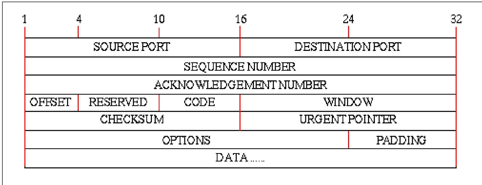
Figure A-9. TCP Segment Header Format.
